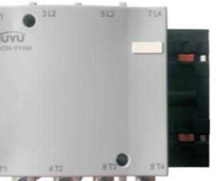
CJX2N-F 系列交流接触器（以下简称接触器），主要用于交流50Hz（或 60Hz），额定工作电压至 1000V、额定工作电流至630A 的电路中，供远距离接通和分断及频繁起动控制交流电动机。该接触器还可方便地加装辅助触头组或空气延时头等附件，并可与适当的热过载继电器组成电磁起动器。
