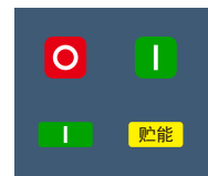
断路器合闸且已储能完毕状态
