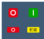
断路器断开且已储能完毕状态
